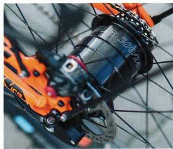
Optional kommt das Trike mit einer Rohloff Speedhub XL Nabenschaltung daher.
