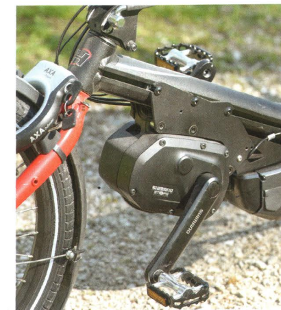
Beim Hase ist der Motor hinter dem Vorderrad positioniert.
