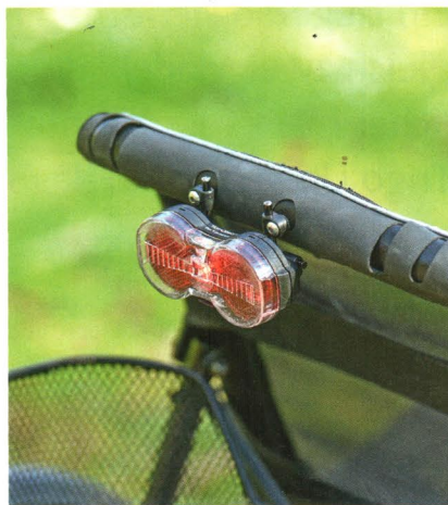
Batterierücklicht angebracht am Rücksitz und wegklappbar zur Korbbefüllung.
