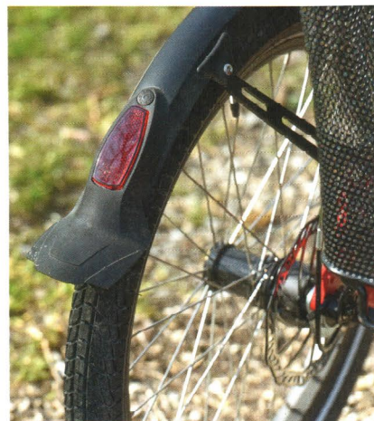
Profilierte Reifen für Wald- und Schotterwege. Schutzlappen gegen Regenwasser.
